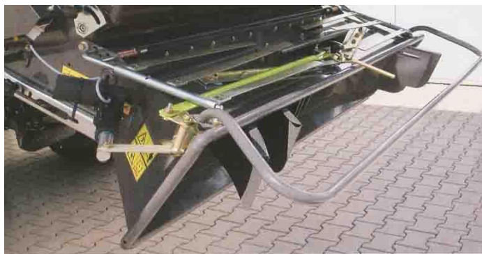
Рис. 1. Система подрібнювача зернозбирального комбайна (фірми Claas, ФРН) для подрібнення та розсівання соломи по полю.
